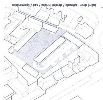
Úprava hmoty podľa výškových obmedzení - využije ústupného podlažia a zvyšného priestoru v uličných kľúčoch
